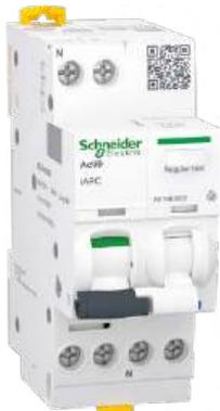
Acti9 iARC ist ein Fehlerlichtbogen-Schutzschalter zum Schutz gegen elektrisch verursachte Brandgefahren. Durch die kontinuierliche Analyse einer großen Anzahl elektrischer Parameter erkennt das Gerät das Auftreten elektrischer Fehlerlichtbögen, die Ursache vieler Brände sind. Es schaltet die betroffenen Stromkreise ab und verringert somit die weitere Brandentstehung.
