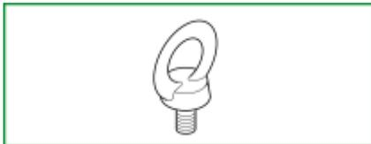
Die Transport-Ösen müssen mit ihrem Ring parallel zu den Seitenwänden des Schrankes ausgerichtet werden.
